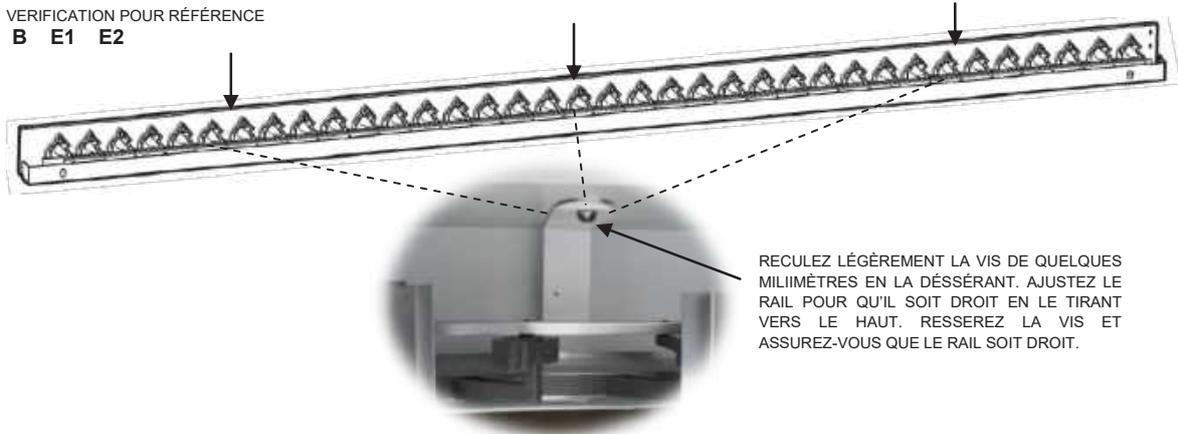
RECULEZ LÉGÈREMENT LA VIS DE QUELQUES MILIMÈTRES EN LA DÉSSÉRANT. AJUSTEZ LE RAIL POUR QU'IL SOIT DROIT EN LE TIRANT VERS LE HAUT. RESSERREZ LA VIS ET ASSUREZ-VOUS QUE LE RAIL SOIT DROIT.
