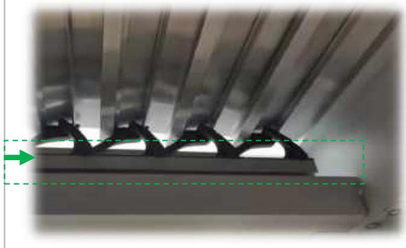
**REMARQUE 2 :** IL EST AUSSI CONSEILLER D'AJUSTER LA FERMETURE DES LAMES AVEC L'ÉCROU CI-DESSOUS QUI SERT A OPTIMISER CETTE FERMETURE. POUR CELA, RECULEZ L'ÉCROU DE QUELQUES MILIMÈTRES EN LE DÉSSÉRANT. FERMER LES LAMES COMPLÈTEMENT EN VOUS ASSURANT QUE L'ENSEMBLE DES LAMES SOIT PLAT. RESSERREZ L'ÉCROU ET VÉRIFIER LA FERMETURE DES LAMES.
